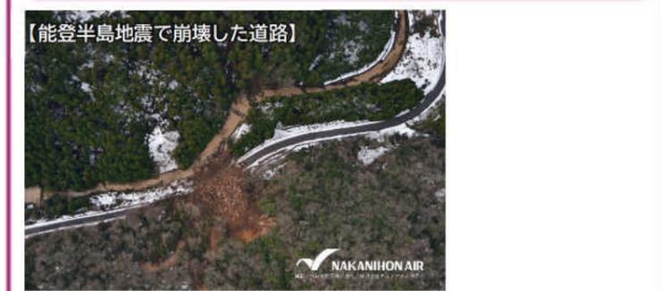
□第2次緊急輸送道路に指定されているが 落石崩落箇所が点在(拡大図:土砂災害特別警戒区域参照) → 緊急輸送道路の代替性及び信頼性の確保
